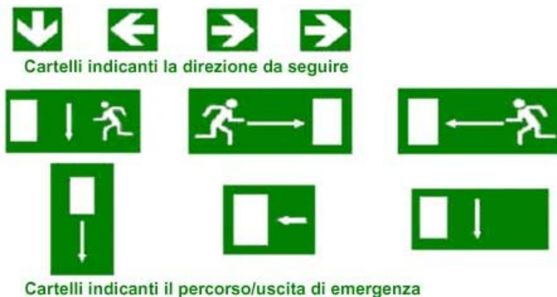
Figura 65 segnalazione delle vie di fuga
