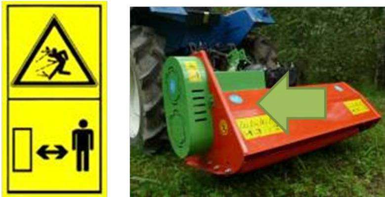
segnale che indica la possibilità di proiezione e di mantenere la distanza di sicurezza
