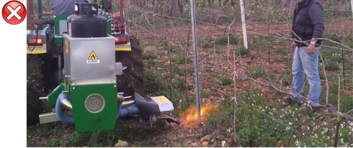
Figura 12 Esempio di mancato rispetto delle zone di sicurezza con macchina per pirodiserbo (rischio proiezione e calore). Si propongono di seguito in tabella alcuni esempi di distanze di sicurezza da dover mantenere da macchine e attrezzature utilizzate nella gestione del vigneto.
