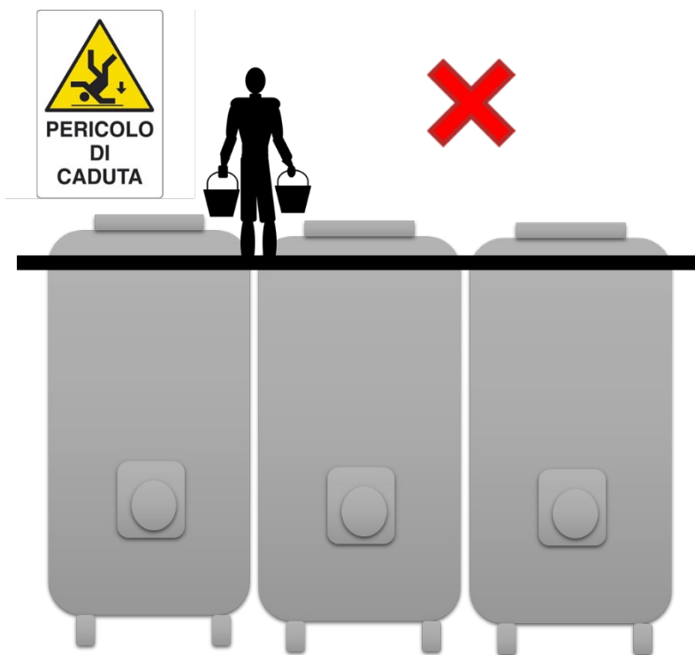
FIGURA 30 OPERATORE CHE LAVORA IN CONDIZIONI DI ESTREMO PERICOLO
