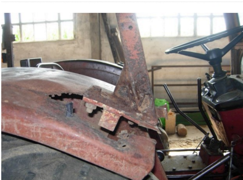
FIGURA 22 ROPS NON CONFORME
