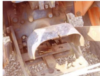
Fig. 6 - presa di forza protetta
