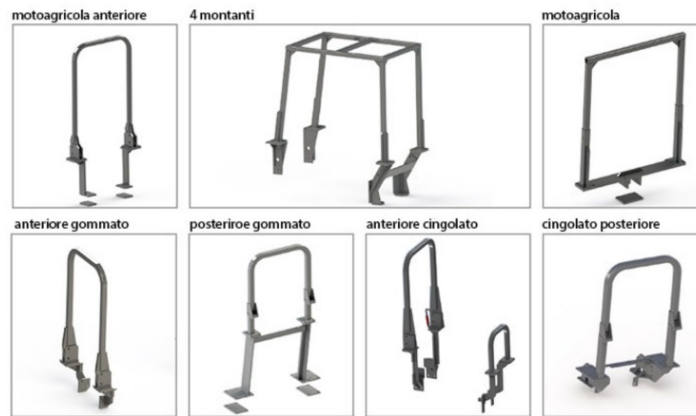
FIGURA 10 STRUTTURE DI PROTEZIONE IN CASO DI RIBALTAMENTO
