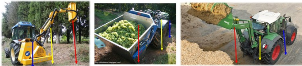
FIGURA 15 - CAUSE DI RIBALTAMENTO DEL TRATTORE: SITUAZIONI PRATICHE
