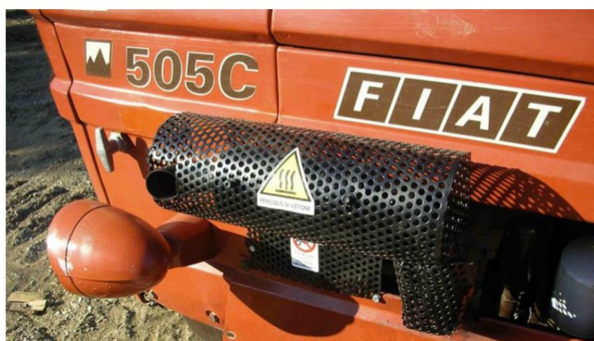
FIGURA 25 ESEMPIO DI PROTEZIONE DI PARTE CALDA
