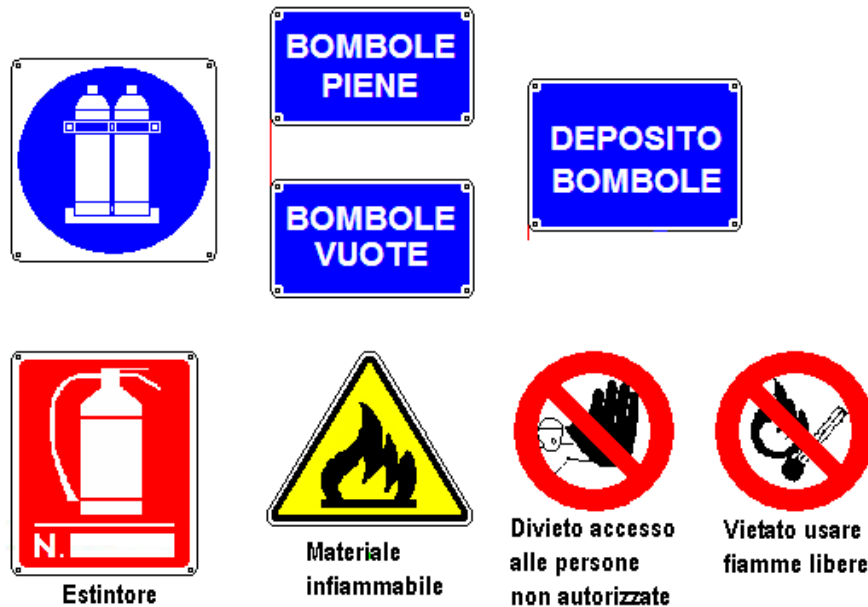
FIGURA 39 ESEMPIO DI CARTELLONISTICA DA TROVARE IN AREA DEPOSITO BOMBOLE IN CANTINA
