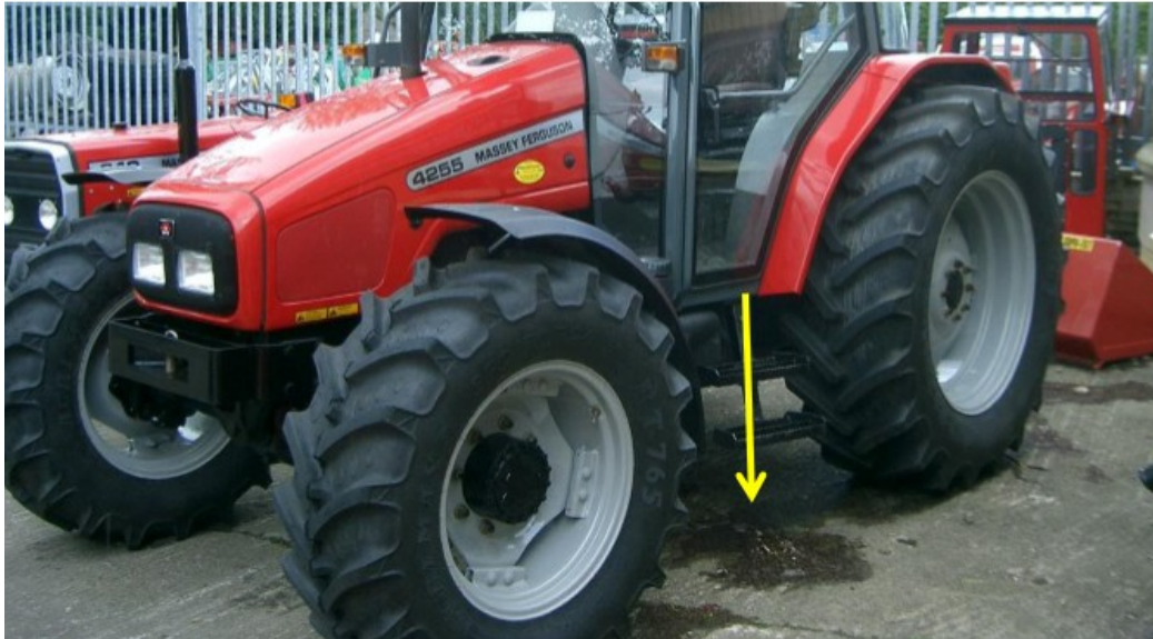
FIGURA 26 DISTANZA DI 55 CM DAL PIANALE DI GUIDA A TERRA
