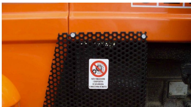
FIGURA 24 ESEMPIO DI ADEGUAMENTO PER PARTI IN MOVIMENTO
